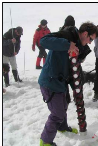
Extraction de la carotte de névé du carottier
