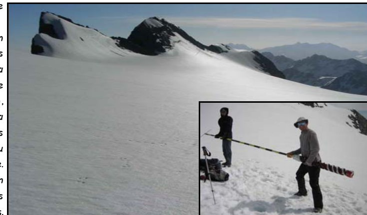
Mesure d'accumulation (carottages) au glacier d'Ossoue, le 25-05-2007
