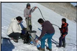
Forage à la sonde à vapeur
