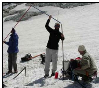
Forage au glacier d'Ossoue pour implantation de balises d'ablation
